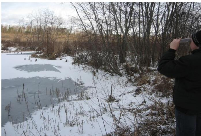
Измерение ширины реки геометрическим методом (подобием треугольников).
